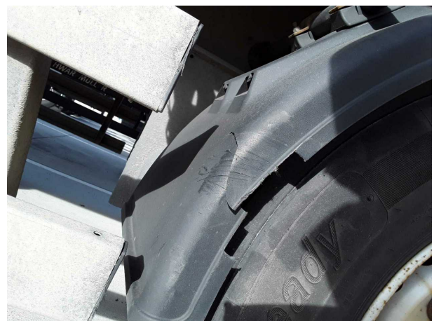
Beschädigung 6: Kotflügel links: Innenkotflügel - gebrochen / gerissen - erneuern
