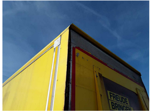
Beschädigung 10: Koffer: Koffer (Korrosion) - verkratzt / verschürft - instandsetzen
