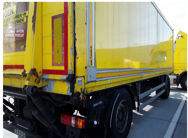
Beschädigung 10: Koffer: Koffer (Korrosion) - verkratzt / verschürft - instandsetzen
