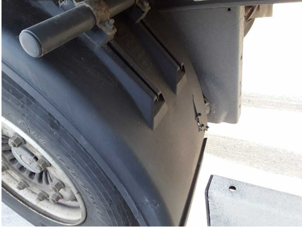
Beschädigung 7: Kofflügel rechts: Innenkofflügel - gebrochen / gerissen - erneuern
