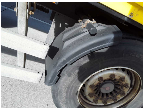
Beschädigung 6: Kotflügel links: Innenkotflügel - gebrochen / gerissen - erneuern
