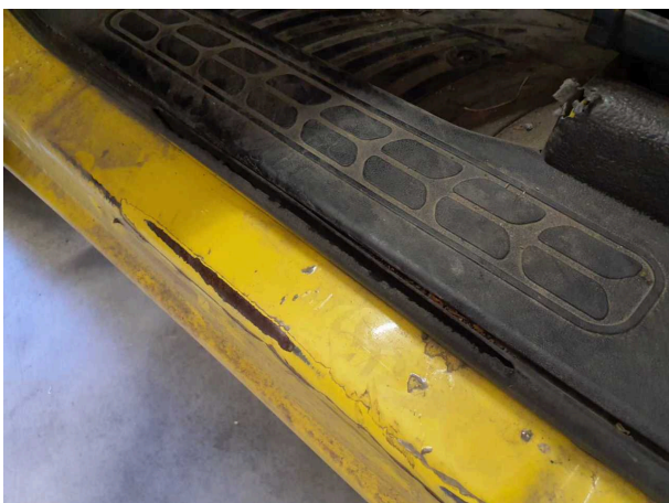
Beschädigung 5: Tür vorn links: Türdichtung - verschlissen - erneuern
