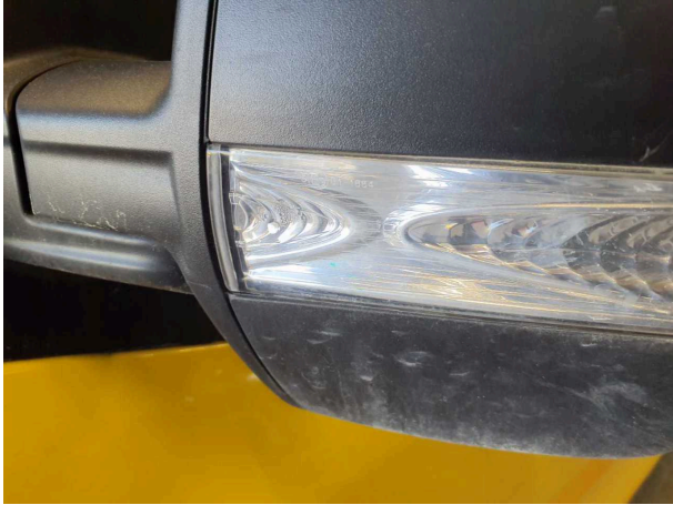
Beschädigung 1: Blinkleuchte: Spiegel links - undicht - erneuern
