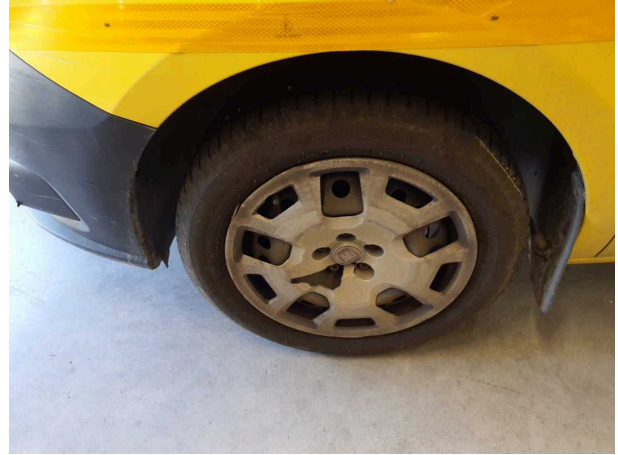
Beschädigung 2: Rad/Reifen: Radblende vorn links - beschädigt - erneuern
