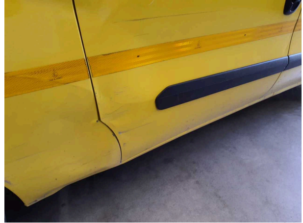
Beschädigung 13: Schiebetür rechts: Schiebetür - beschädigt - instandsetzen und lackieren
