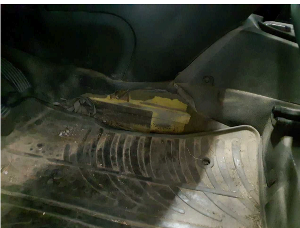
Beschädigung 10: Verkleidungen/Abdeckungen: Teppichboden vorn links - verschlissen - erneuern
