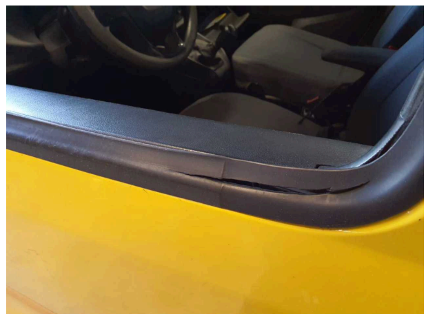
Beschädigung 6: Tür vorn links: Schachtleiste außen - beschädigt - erneuern
