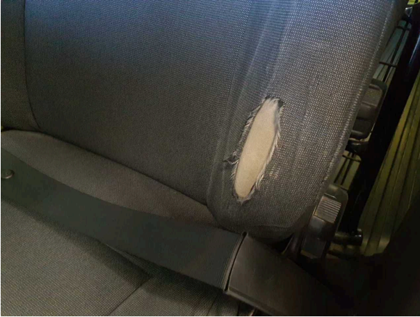
Beschädigung 7: Sitz vorn: Lehnenbezug links - verschlissen - erneuern
