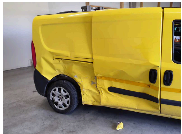
Beschädigung 7: Karosserie: Karosserie (Unfallschaden) - beschädigt - instandsetzen
