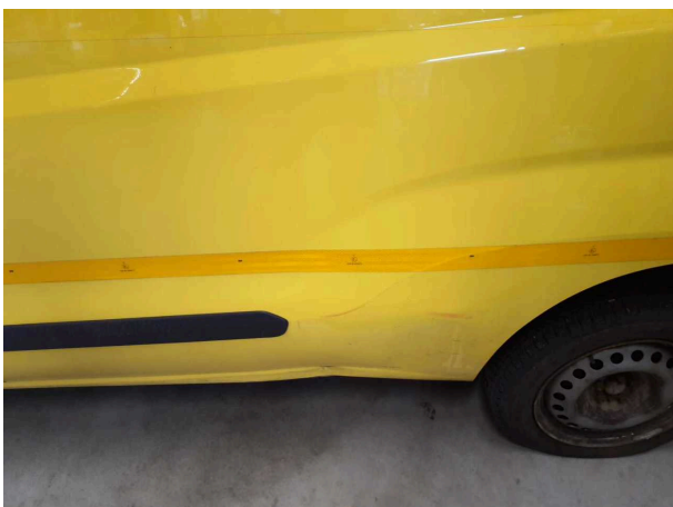
Beschädigung 6: Seitenwand links: Seitenwand - beschädigt - instandsetzen und lackieren
