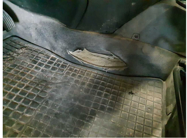
Beschädigung 3: Verkleidungen/Abdeckungen: Teppichboden vorn links - verschlissen - erneuern
