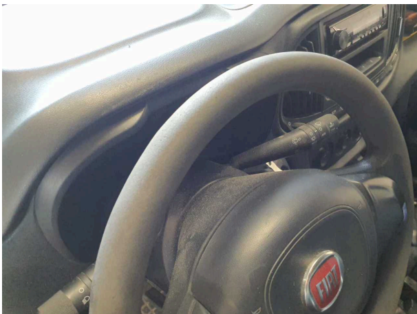
Beschädigung 4: Lenkanlage: Lenkrad - verschlissen - erneuern
