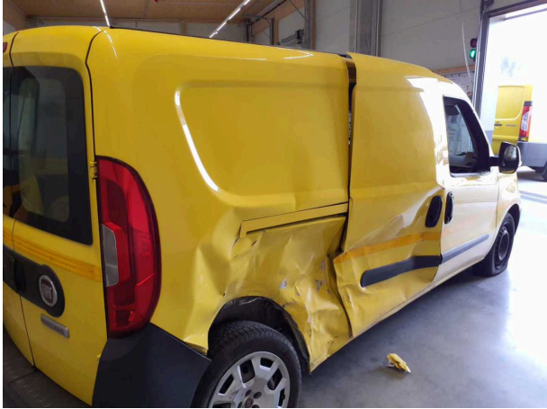
Beschädigung 7: Karosserie: Karosserie (Unfallschaden) - beschädigt - instandsetzen
