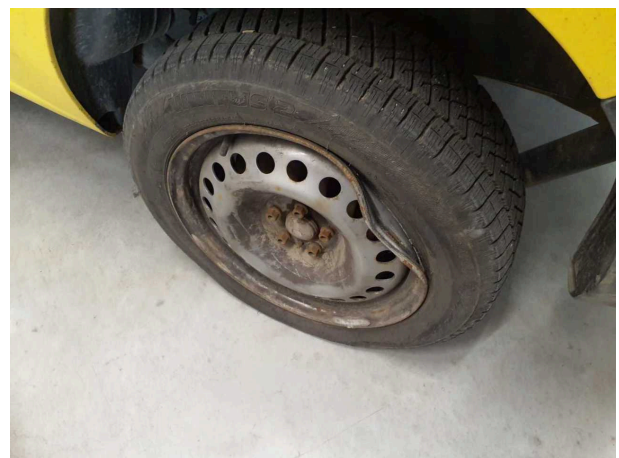
Beschädigung 1: Rad/Reifen: Stahlrad - beschädigt - erneuern
