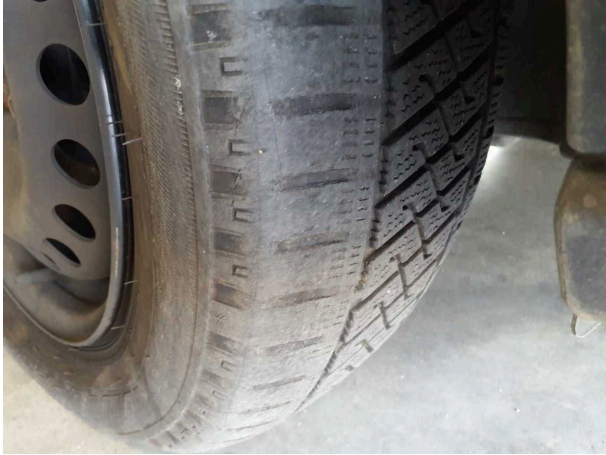
Beschädigung 2: Rad/Reifen: Reifen vorn - verschlissen - erneuern
