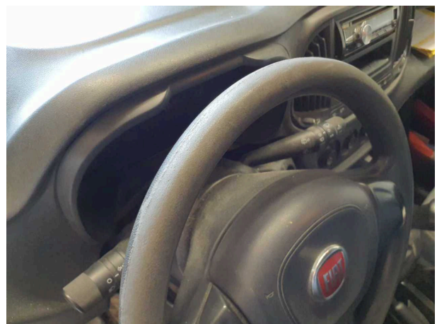
Beschädigung 7: Lenkanlage: Lenkrad - verschlissen - erneuern
