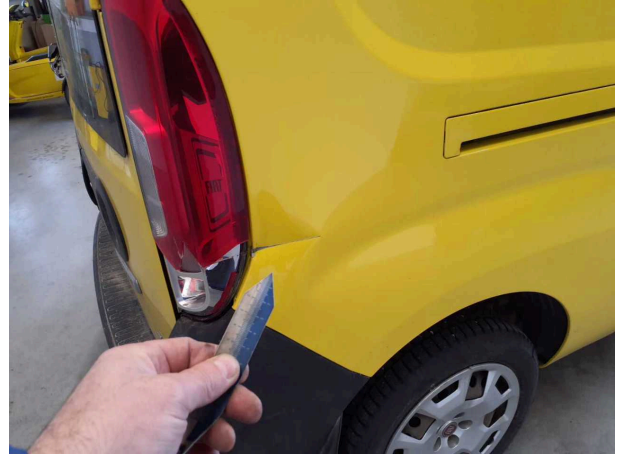
Beschädigung 9: Seitenwand rechts: Seitenwand - beschädigt - instandsetzen und lackieren
