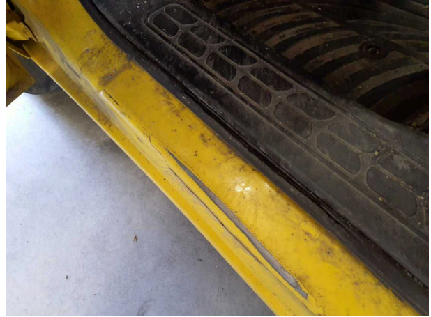
Beschädigung 4: Tür vorn links: Türdichtung - verschlissen - erneuern
