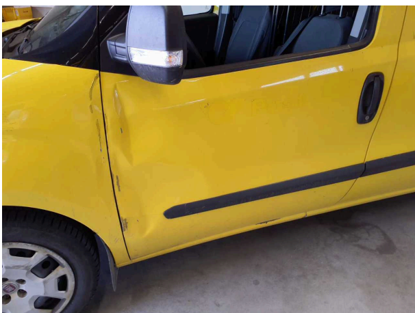
Beschädigung 11: Tür vorn links: Tür - beschädigt - erneuern
