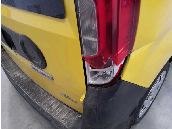
Beschädigung 3: Heckleuchte: Heckleuchte rechts - beschädigt - erneuern
