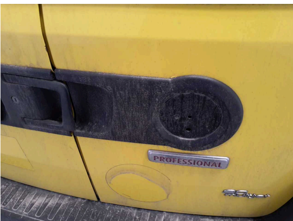
Beschädigung 1: Heckklappe/-tür: Emblem - fehlt - erneuern
