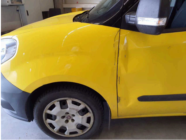
Beschädigung 8: Kotflügel links: Kotflügel links - beschädigt - erneuern
