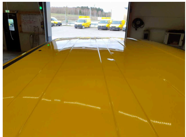
Beschädigung 10: Karosserie: Karosserie - Hagelschaden - sanft instandsetzen
