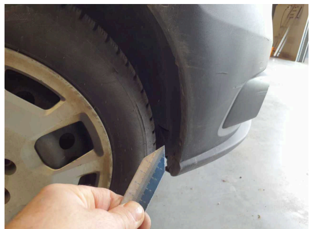
Beschädigung 2: Kotflügel rechts: Innenkotflügel - beschädigt - erneuern
