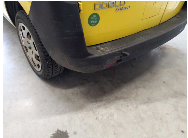
Beschädigung 5: Stossfänger hinten: Stossfänger hinten - beschädigt - erneuern
