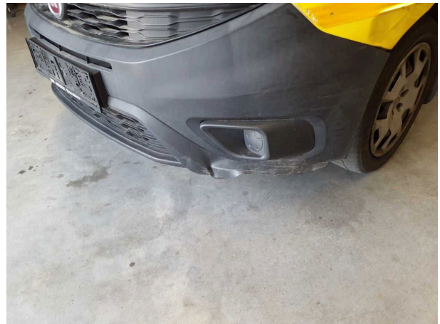
Beschädigung 10: Stossfänger vorn: Stossfänger vorn - beschädigt - erneuern
