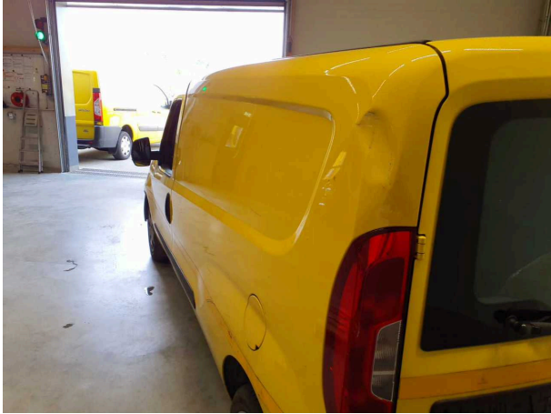
Beschädigung 12: Seitenwand links: Seitenwand - beschädigt - instandsetzen und lackieren
