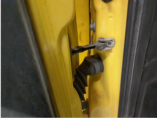
Beschädigung 1: Tür vorn links: Fangband / Feststeller - Geräusch - erneuern
