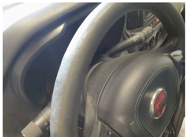
Beschädigung 11: Lenkanlage: Lenkrad - verschlissen - erneuern
