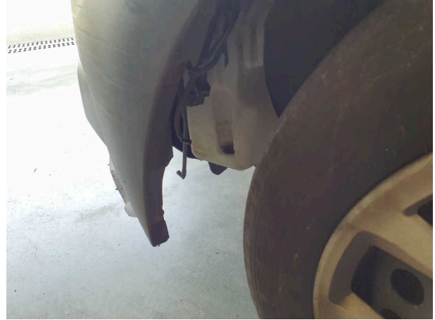
Beschädigung 3: Kotflügel links: Innenkotflügel - beschädigt - erneuern
