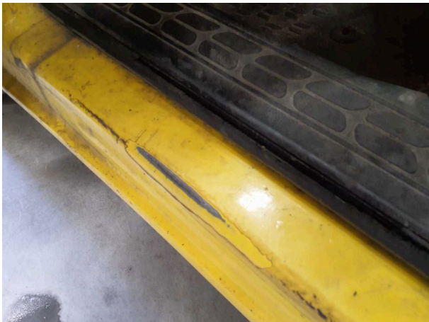
Beschädigung 4: Tür vorn links: Türdichtung - verschlissen - erneuern
