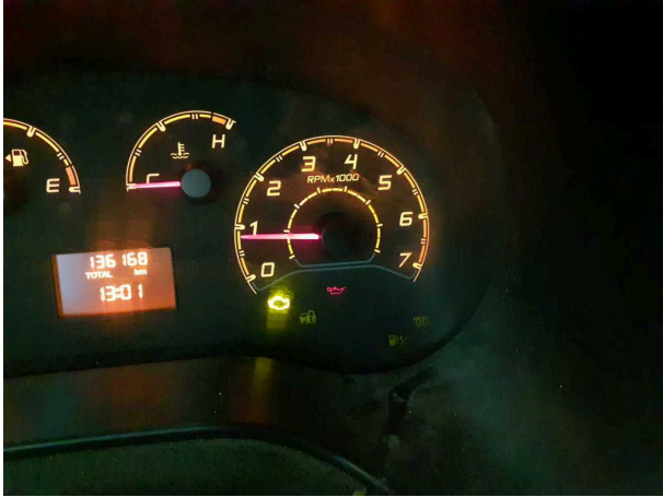
Beschädigung 7: Motor: Motor (Motorkontrolle, keine Leistung) - Befund festlegen - Diagnose durchführen
