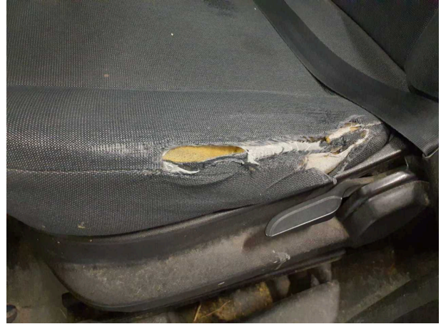
Beschädigung 6: Sitz vorn: Sitzpolster links - verschlissen - erneuern
