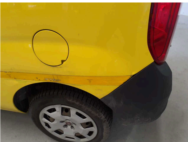
Beschädigung 18: Seitenwand links: Seitenwand - beschädigt - instandsetzen und lackieren
