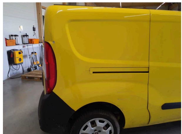
Beschädigung 19: Seitenwand rechts: Seitenwand - beschädigt - instandsetzen und lackieren
