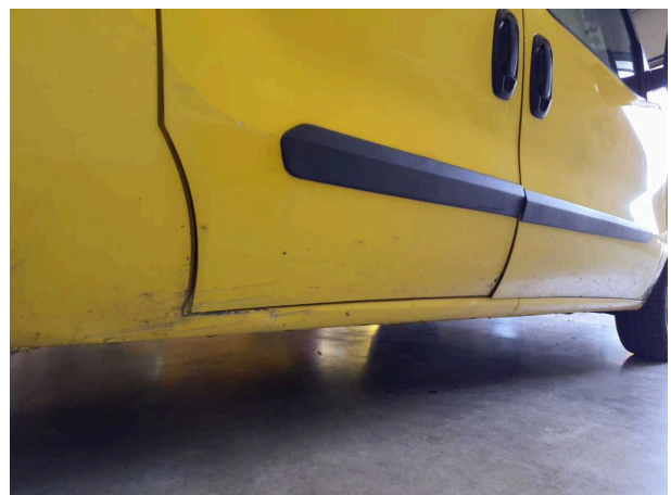
Beschädigung 15: Schiebetür rechts: Schiebetür - beschädigt - instandsetzen und lackieren
