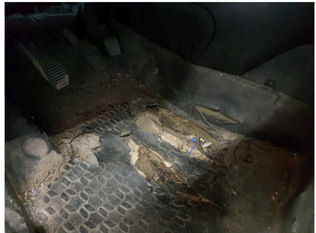
Beschädigung 13: Verkleidungen/Abdeckungen: Teppichboden vorn links - verschlissen - erneuern
