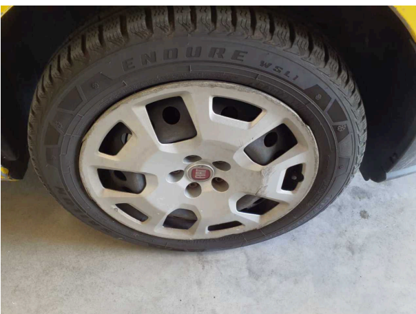
Beschädigung 2: Rad/Reifen: Radblende vorn rechts - beschädigt - erneuern
