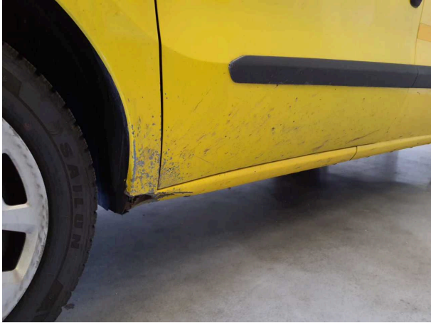
Beschädigung 11: Tür vorn links: Tür - beschädigt - instandsetzen und lackieren
