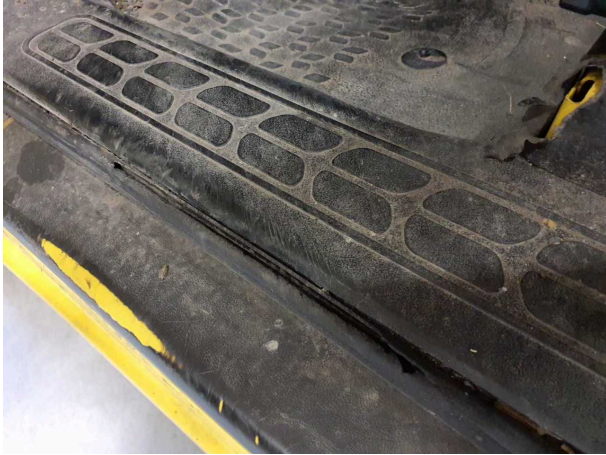
Beschädigung 5: Tür vorn links: Türdichtung - verschlissen - erneuern
