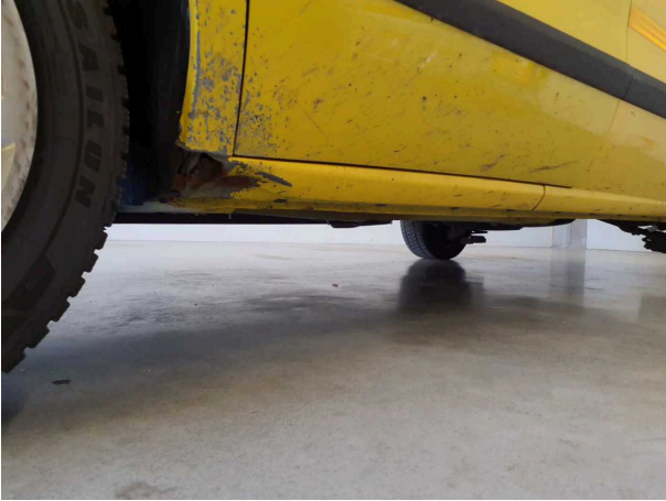
Beschädigung 16: Schweller links: Einstieg - beschädigt - instandsetzen und lackieren
