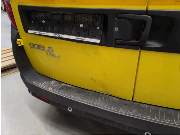
Beschädigung 2: Heckklappe/-tür: Hecktür links - beschädigt - instandsetzen und lackieren
