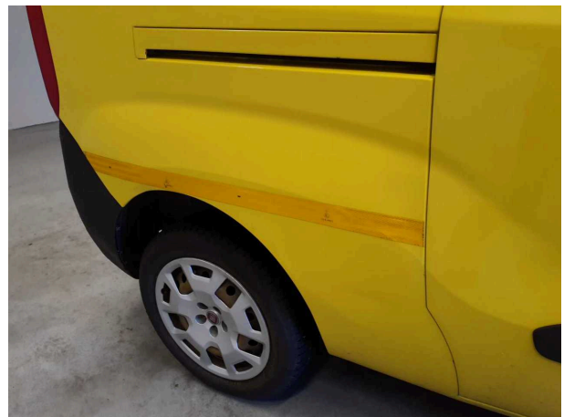
Beschädigung 6: Seitenwand rechts: Seitenwand - beschädigt - instandsetzen und lackieren
