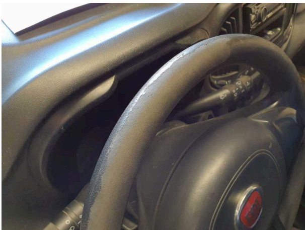
Beschädigung 4: Lenkanlage: Lenkrad - verschlissen - erneuern
