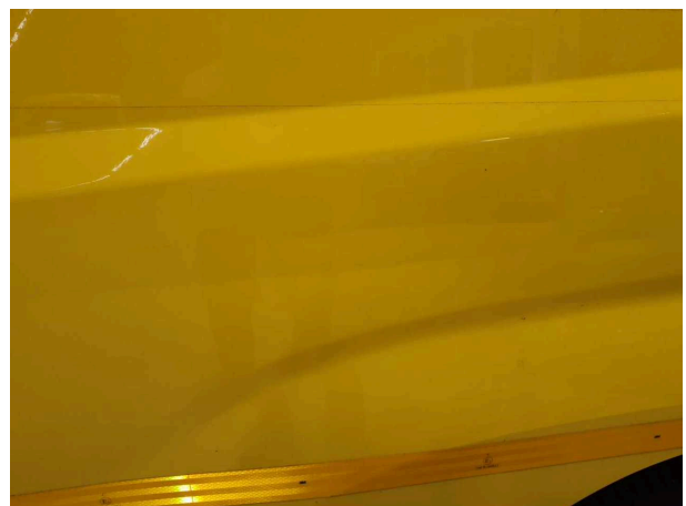
Beschädigung 7: Seitenwand links: Seitenwand - beschädigt - instandsetzen und lackieren
