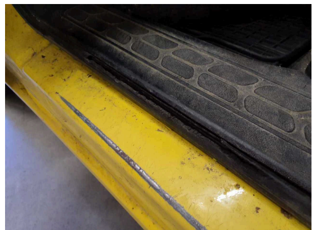
Beschädigung 1: Tür vorn links: Türdichtung - verschlissen - erneuern
