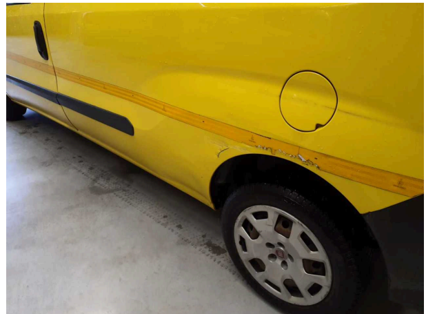
Beschädigung 8: Seitenwand links: Seitenwand - beschädigt - instandsetzen und lackieren
