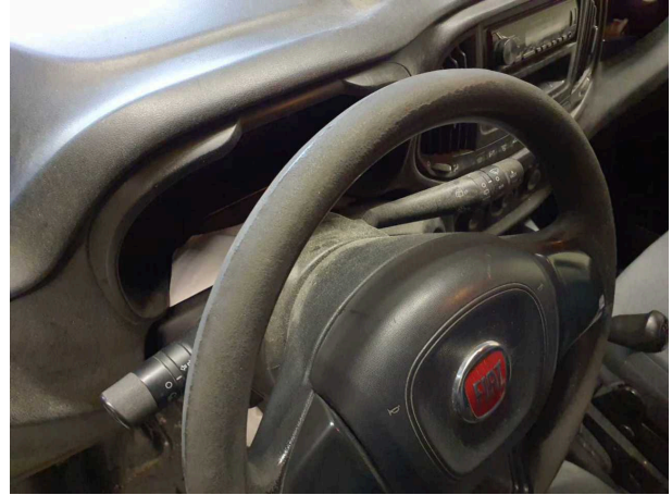
Beschädigung 7: Lenkanlage: Lenkrad - verschlissen - erneuern
