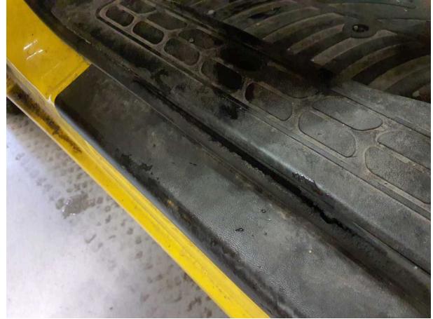
Beschädigung 3: Tür vorn links: Türdichtung - verschlissen - erneuern
