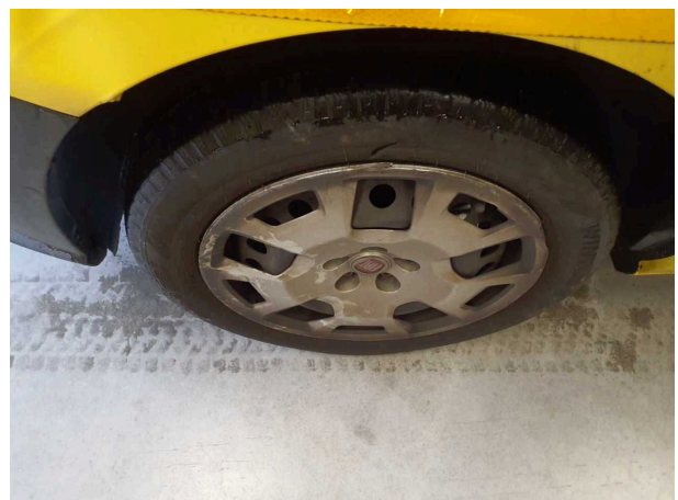
Beschädigung 1: Rad/Reifen: Radblende vom links - beschädigt - erneuern
