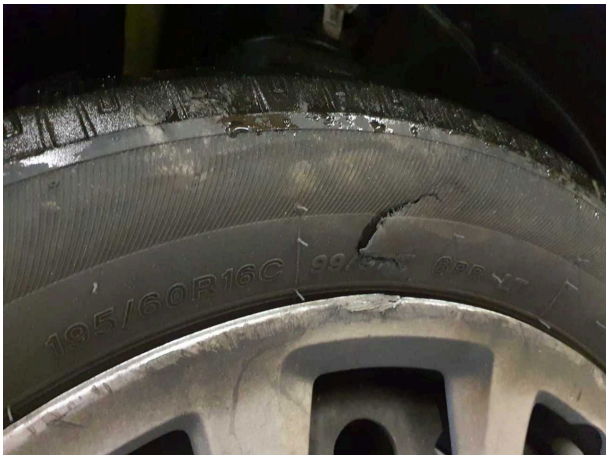
Beschädigung 4: Rad/Reifen: Reifen vorn links - beschädigt - erneuern
