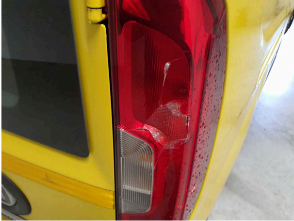
Beschädigung 2: Heckleuchte: Heckleuchte rechts - beschädigt - erneuern
