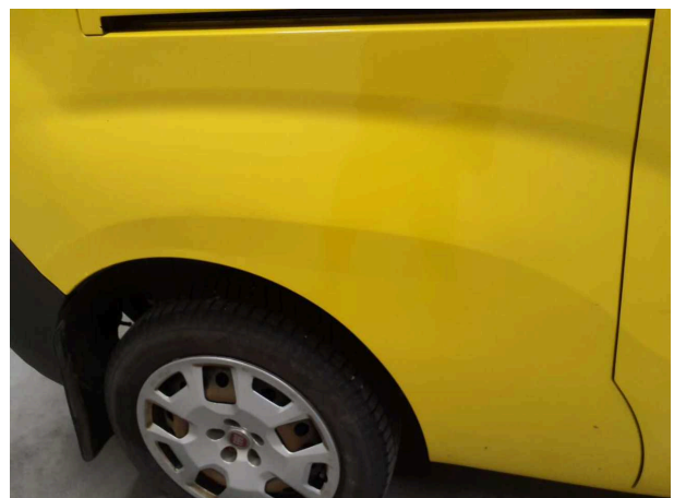
Beschädigung 12: Seitenwand rechts: Seitenwand - beschädigt - instandsetzen und lackieren
