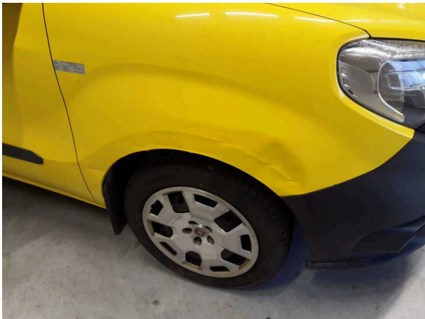
Beschädigung 11: Kotflügel rechts: Kotflügel rechts - beschädigt - erneuern
