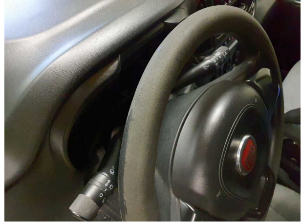
Beschädigung 9: Lenkanlage: Lenkrad - verschlissen - erneuern
