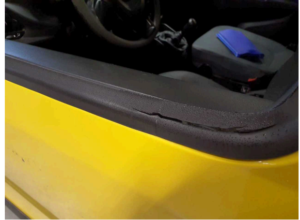
Beschädigung 4: Tür vorn links: Schachtleiste außen - beschädigt - erneuern
