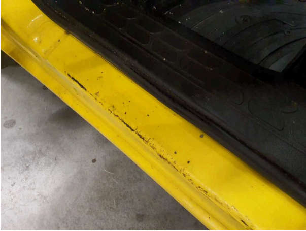
Beschädigung 3: Tür vorn links: Türdichtung - verschlissen - erneuern
