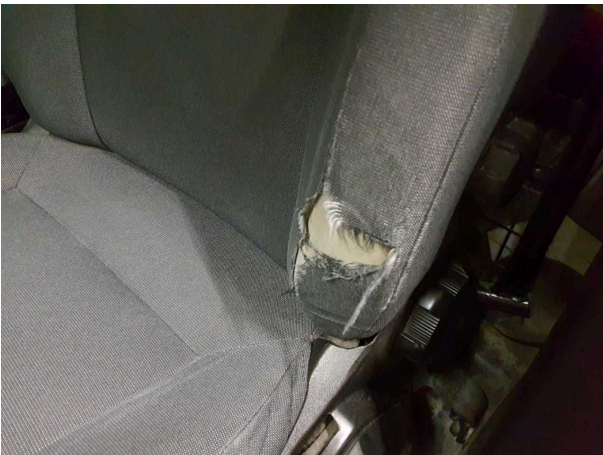
Beschädigung 5: Sitz vorn: Lehnenbezug links - verschlissen - erneuern
