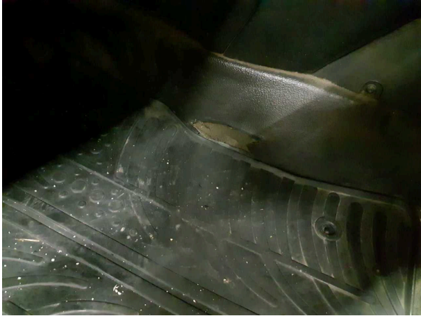
Beschädigung 8: Verkleidungen/Abdeckungen: Teppichboden vorn links - verschlissen - erneuern
