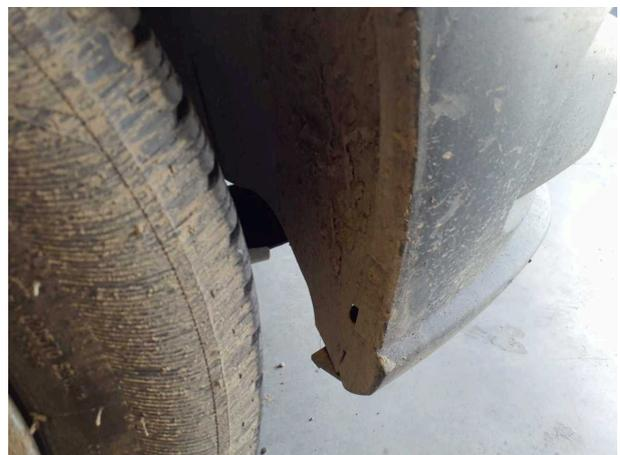
**Beschädigung 3:** Kotflügel rechts: Innenkotflügel - beschädigt - erneuern
