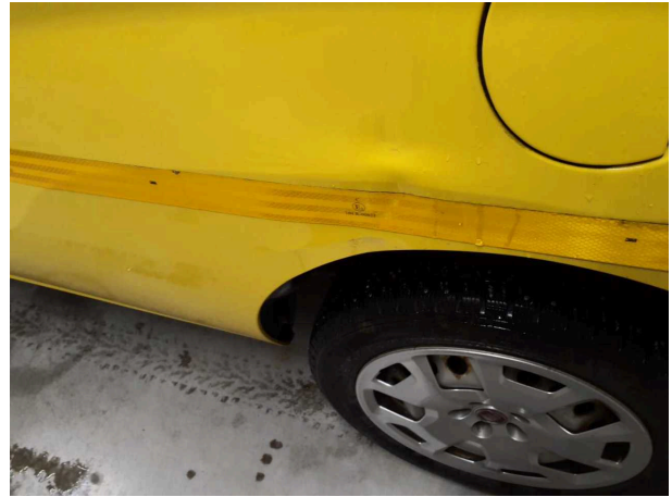
Beschädigung 15: Seitenwand links: Seitenwand - beschädigt - instandsetzen und lackieren
