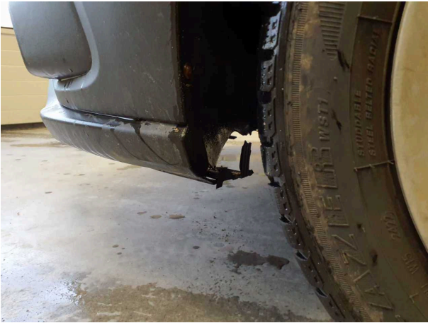
Beschädigung 2: Kotflügel links: Innenkotflügel - beschädigt - erneuern
