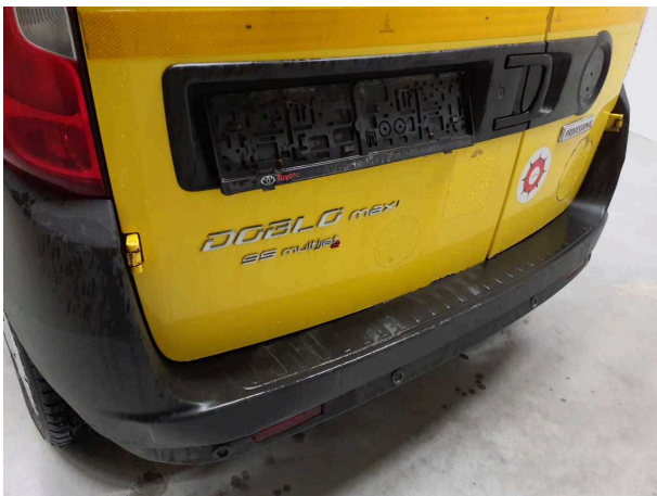
Beschädigung 9: Heckklappe/-tür: Hecktür links - Korrosion - instandsetzen und lackieren
