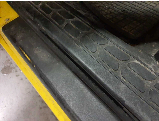
Beschädigung 4: Tür vorn links: Türdichtung - verschlissen - erneuern
