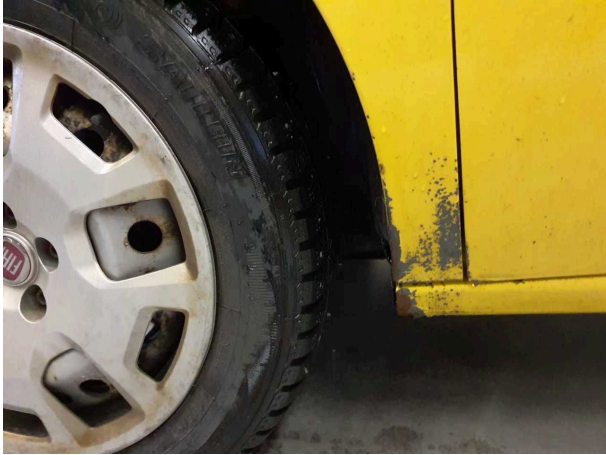
Beschädigung 7: Kotflügel links: Kotflügel links - beschädigt - instandsetzen und lackieren
