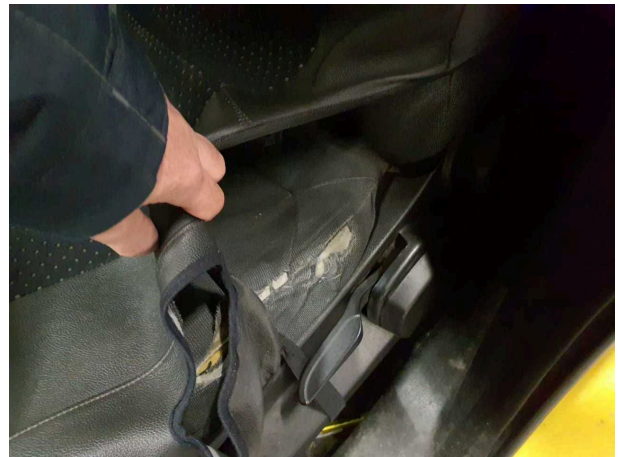
Beschädigung 5: Sitz vorn: Sitzpolster links - verschlissen - erneuern
