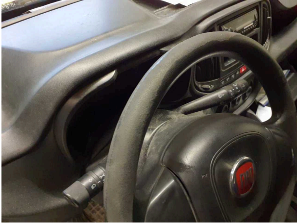
Beschädigung 11: Lenkanlage: Lenkrad - verschlissen - erneuern
