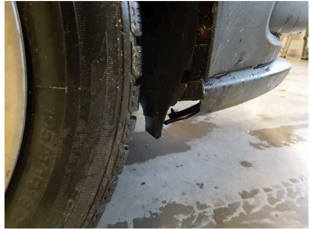
Beschädigung 3: Kotflügel rechts: Innenkotflügel - beschädigt - erneuern
