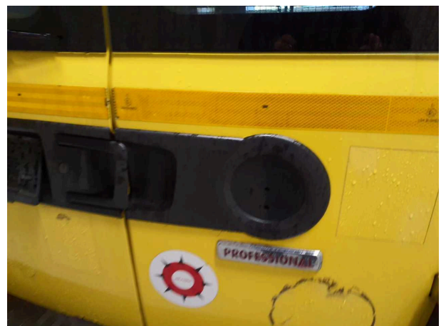
Beschädigung 1: Heckklappe/-tür: Emblem - fehlt - erneuern
