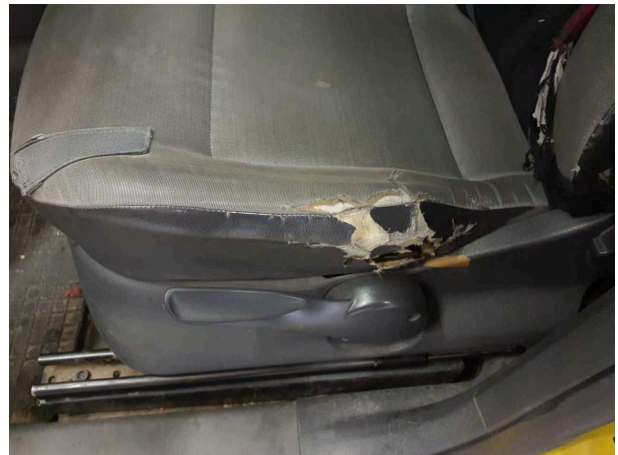
Beschädigung 5: Sitz vorn: Sitzbezug links - verschlissen - erneuern
