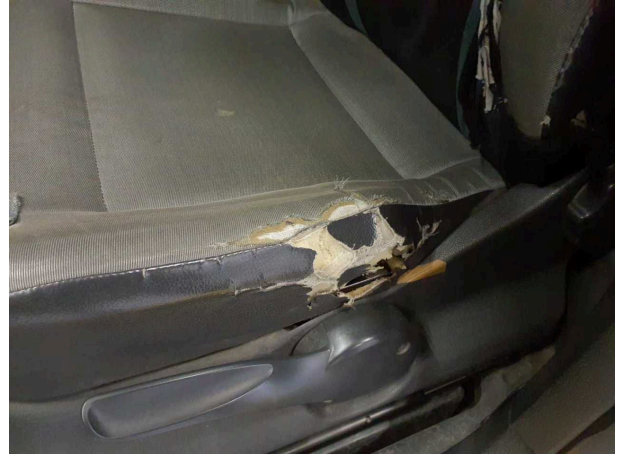
Beschädigung 3: Sitz vorn: Sitzpolster links - verschlissen - erneuern
