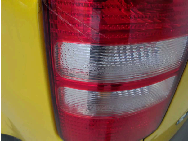
Beschädigung 2: Heckleuchte: Heckleuchte links - beschädigt - erneuern
