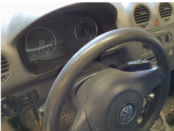
Beschädigung 6: Lenkanlage: Lenkrad - verschlissen - erneuern
