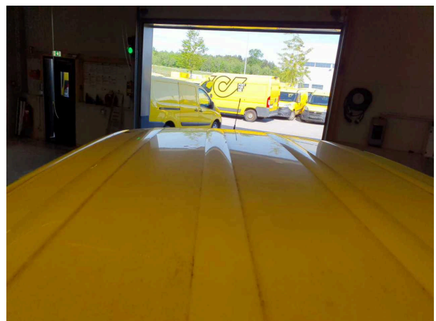
Beschädigung 11: Fahrzeugdach: Dach - Delle(n) - sanft instandsetzen
