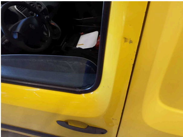
Beschädigung 13: Tür vorn links: Tür - verkratzt / verschürft - instandsetzen und lackieren
