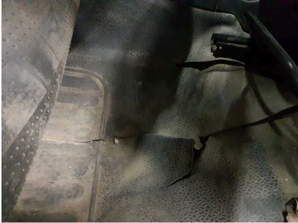
Beschädigung 12: Verkleidungen/Abdeckungen: Teppichboden vorn links - verschlissen - erneuern
