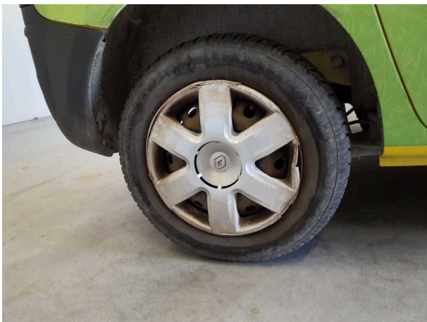
Beschädigung 2: Rad/Reifen: Radblende hinten rechts - beschädigt - erneuern
