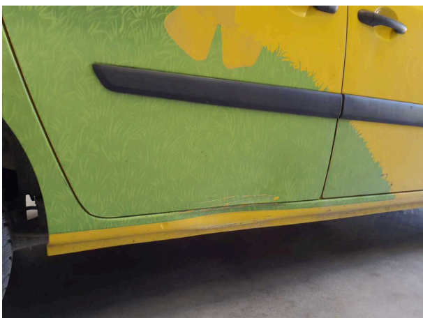
Beschädigung 15: Schiebetür rechts: Schiebetür - beschädigt - kein Abzug
