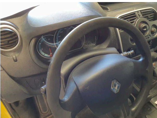
Beschädigung 10: Lenkanlage: Lenkrad - verschlissen - erneuern
