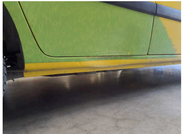
Beschädigung 14: Schweller rechts: Einstieg - beschädigt - instandsetzen und lackieren
