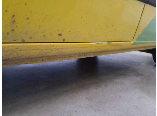
Beschädigung 6: Schweller links: Einstieg - verkratzt / verschürft - instandsetzen und lackieren
