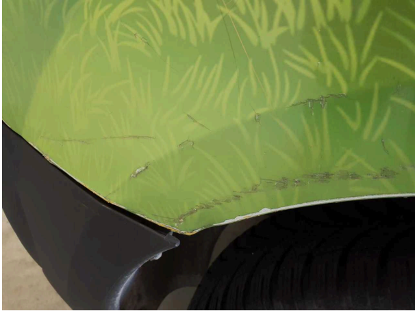
Beschädigung 16: Seitenwand rechts: Seitenwand (Unterteil) - beschädigt - instandsetzen und lackieren
