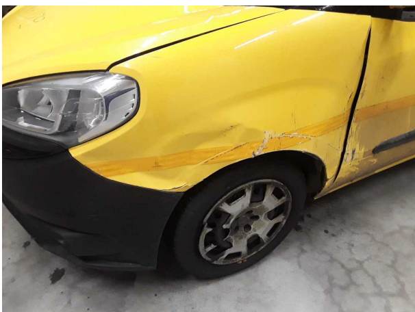
Beschädigung 13: Karosserie: Karosserie (Unfallschaden,) - beschädigt - instandsetzen
