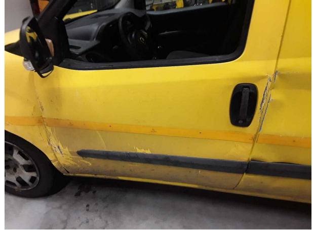
Beschädigung 10: Tür vorn links: Tür - beschädigt - erneuern
