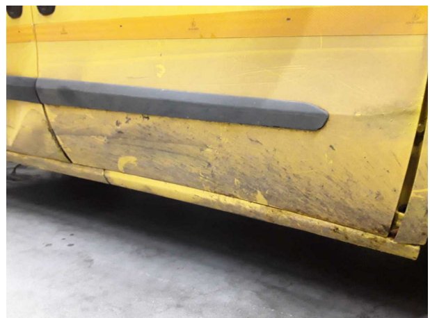
Beschädigung 12: Tür vorn rechts: Tür - beschädigt - erneuern
