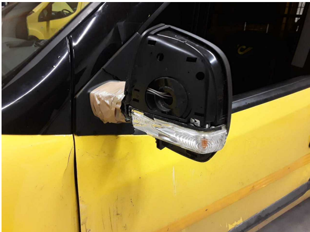
Beschädigung 5: Außenspiegel links: Spiegelgehäuse - beschädigt - erneuern
