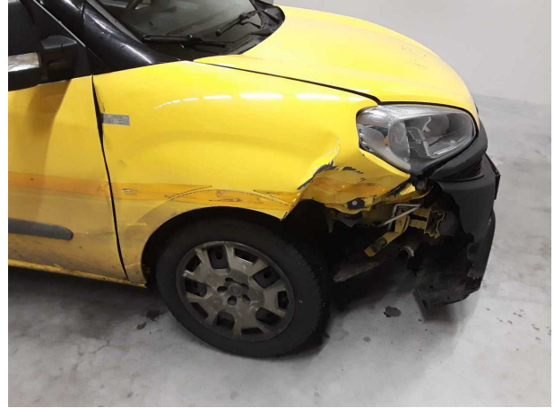
Beschädigung 13: Karosserie: Karosserie (Unfallschaden,) - beschädigt - instandsetzen
