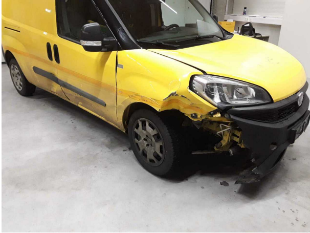
Beschädigung 13: Karosserie: Karosserie (Unfallschaden,) - beschädigt - instandsetzen
