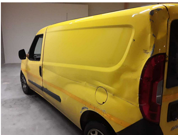
Beschädigung 11: Seitenwand links: Seitenwand - beschädigt - instandsetzen und lackieren
