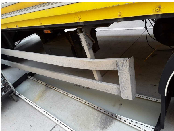
Beschädigung 3: Anbauteil rechts: Unterfahrtschutzprofil - verformt - instandsetzen
