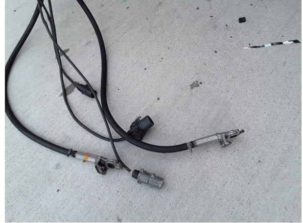
Beschädigung 1: Druckluftanlage: Kupplungskopf Steuerleitung - beschädigt - instandsetzen
