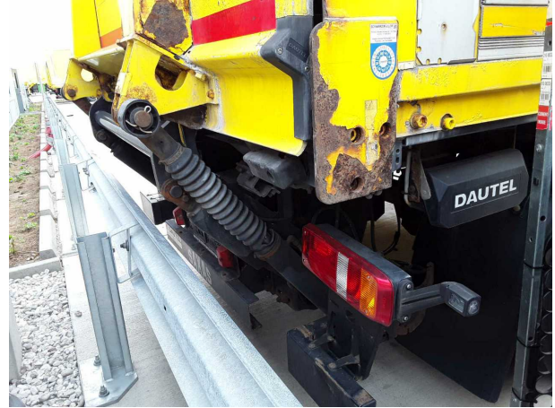
Beschädigung 7: Ladebordwand: Hubzylinder (Manschette) - gebrochen / gerissen - erneuern
