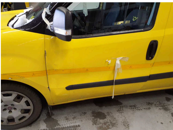
Beschädigung 9: Tür vorn links: Tür - beschädigt - erneuern
