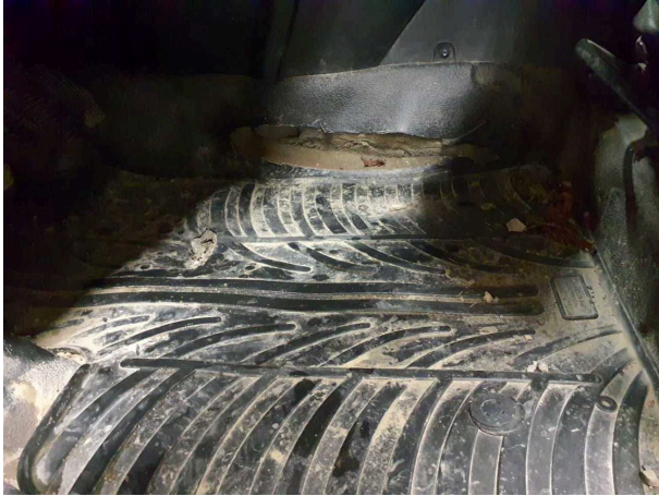
Beschädigung 6: Verkleidungen/Abdeckungen: Teppichboden vorn links - verschlissen - erneuern
