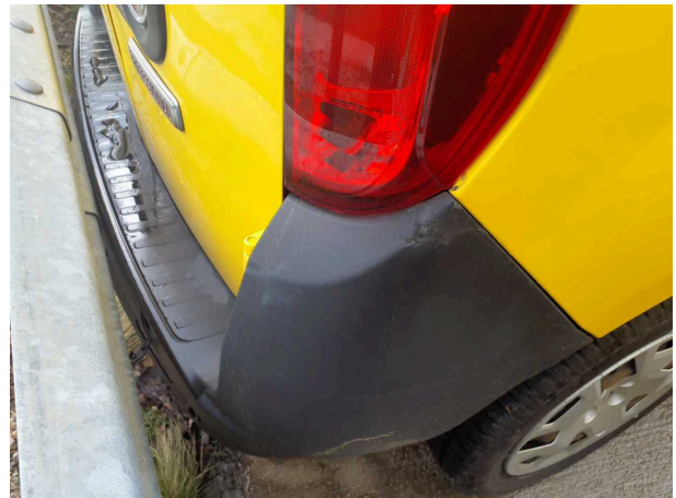
Beschädigung 2: Stossfänger hinten: Stossfänger hinten - beschädigt - erneuern
