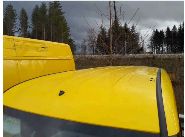
Beschädigung 6: Karosserie: Karosserie - Hagelschaden - sanft instandsetzen
