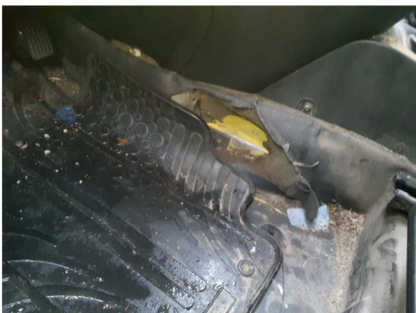
Beschädigung 3: Verkleidungen/Abdeckungen: Teppichboden vorn links - verschlissen - erneuern
