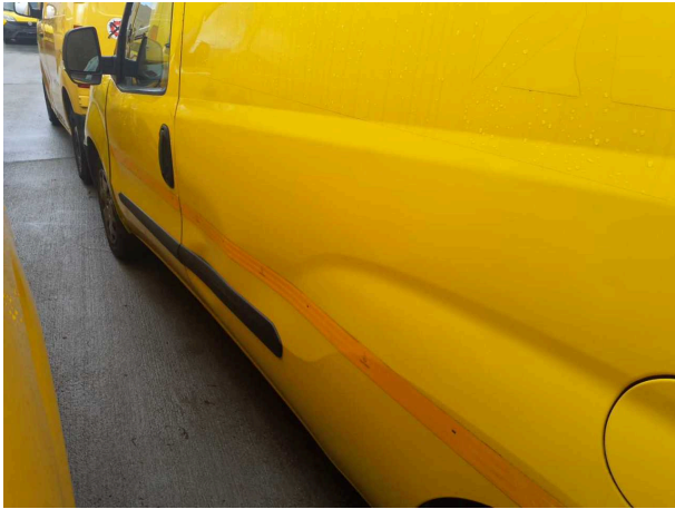
Beschädigung 5: Seitenwand links: Seitenwand - beschädigt - instandsetzen und lackieren
