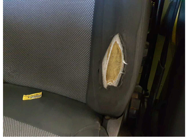
Beschädigung 9: Sitz vorn: Lehnenbezug links - verschlissen - erneuern
