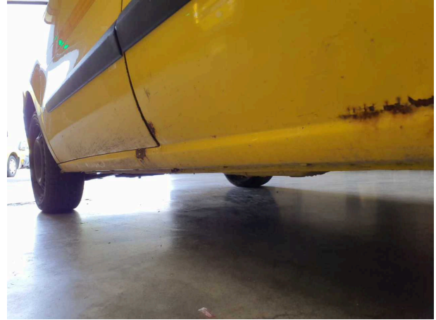
Beschädigung 19: Schweller links: Einstieg - beschädigt - instandsetzen und lackieren
