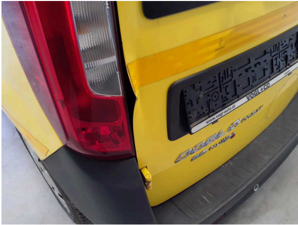
Beschädigung 13: Heckklappe/-tür: Hecktür links - beschädigt - instandsetzen und lackieren
