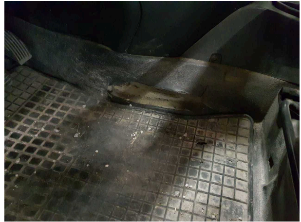
Beschädigung 14: Verkleidungen/Abdeckungen: Teppichboden vorn links - verschlissen - erneuern
