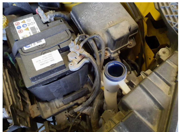
Beschädigung 1: Scheibenreinigung: Deckel Waschbehälter - fehlt - erneuern
