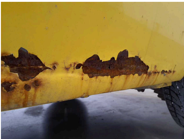
Beschädigung 22: Seitenwand links: Seitenwand - beschädigt - erneuern
