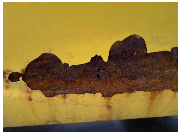
Beschädigung 22: Seitenwand links: Seitenwand - beschädigt - erneuern
