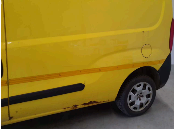
Beschädigung 22: Seitenwand links: Seitenwand - beschädigt - erneuern
