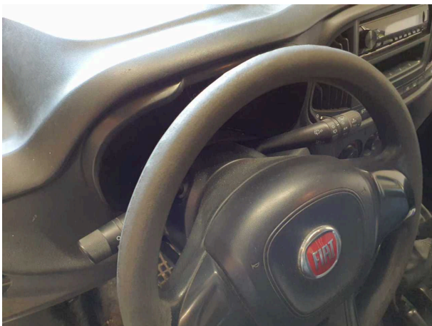
Beschädigung 15: Lenkanlage: Lenkrad - verschlissen - erneuern
