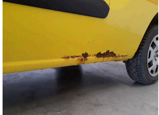
Beschädigung 22: Seitenwand links: Seitenwand - beschädigt - erneuern
