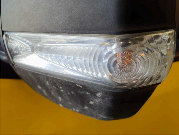
Beschädigung 2: Blinkleuchte: Spiegel links - undicht - erneuern
