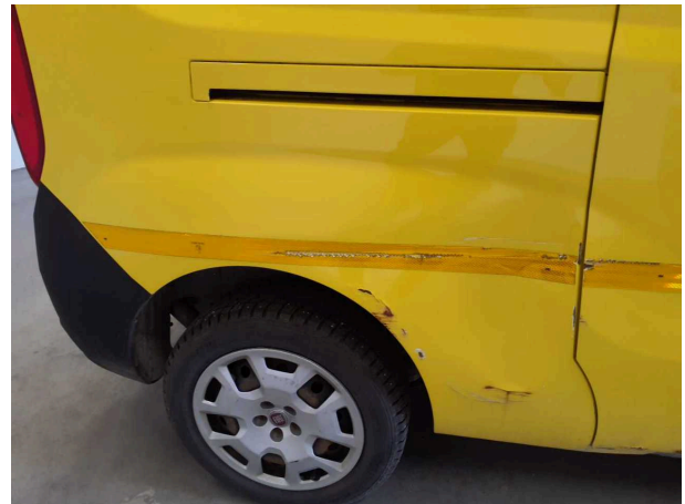
Beschädigung 21: Seitenwand rechts: Seitenwand - beschädigt - instandsetzen und lackieren
