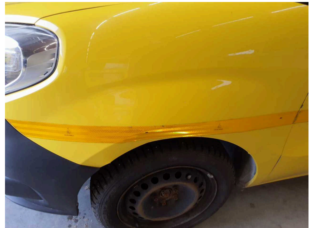
Beschädigung 11: Kotflügel links: Kotflügel links - beschädigt - instandsetzen und lackieren
