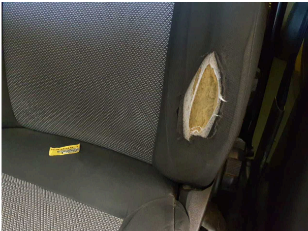
Beschädigung 10: Sitz vorn: Lehnpolster links - verschlissen - erneuern
