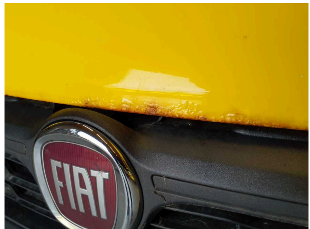
Beschädigung 16: Motorhaube: Motorhaube - Korrosion - instandsetzen und lackieren
