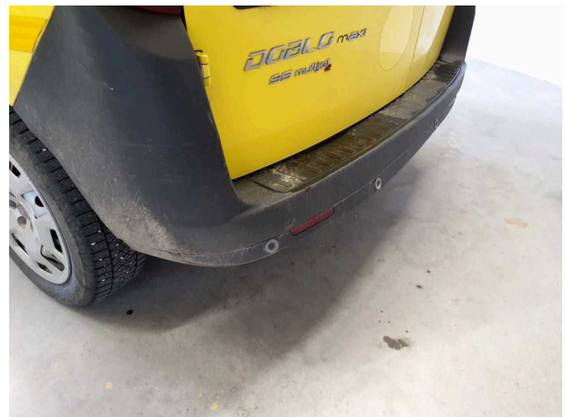
Beschädigung 4: Stossfänger hinten: Stossfänger hinten - beschädigt - erneuern
