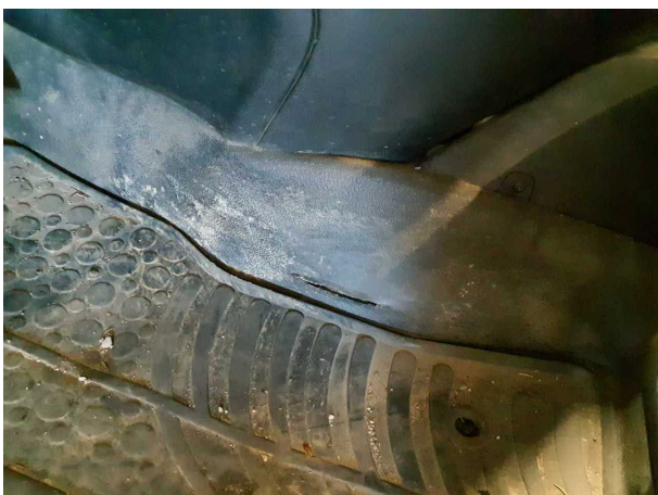
Beschädigung 10: Verkleidungen/Abdeckungen: Teppichboden vorn links - verschlissen - erneuern
