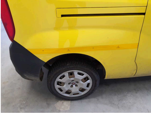
Beschädigung 13: Seitenwand rechts: Seitenwand - beschädigt - instandsetzen und lackieren
