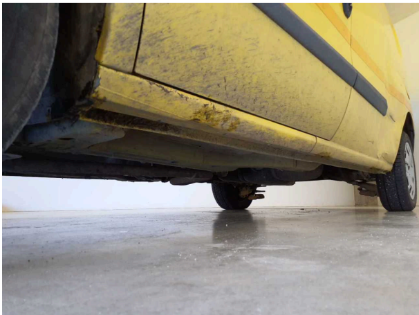
Beschädigung 8: Schweller links: Einstieg - beschädigt - instandsetzen und lackieren
