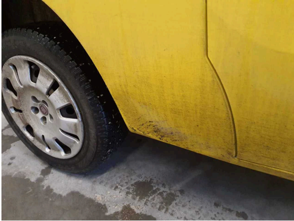
Beschädigung 14: Seitenwand rechts: Seitenwand - beschädigt - instandsetzen und lackieren
