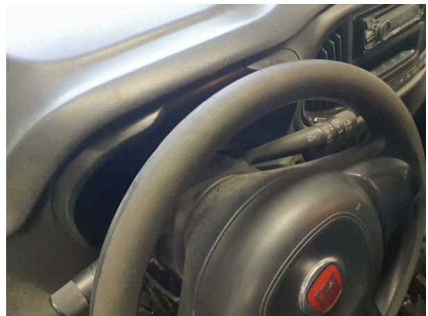
Beschädigung 11: Lenkanlage: Lenkrad - verschlissen - erneuern
