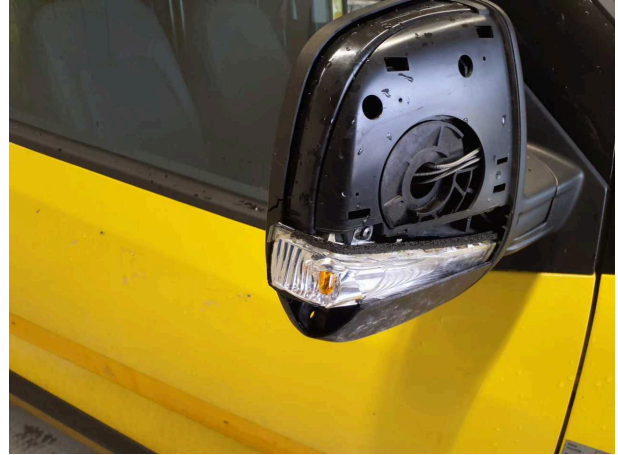
Beschädigung 4: Außenspiegel rechts: Spiegelgehäuse - beschädigt - erneuern
