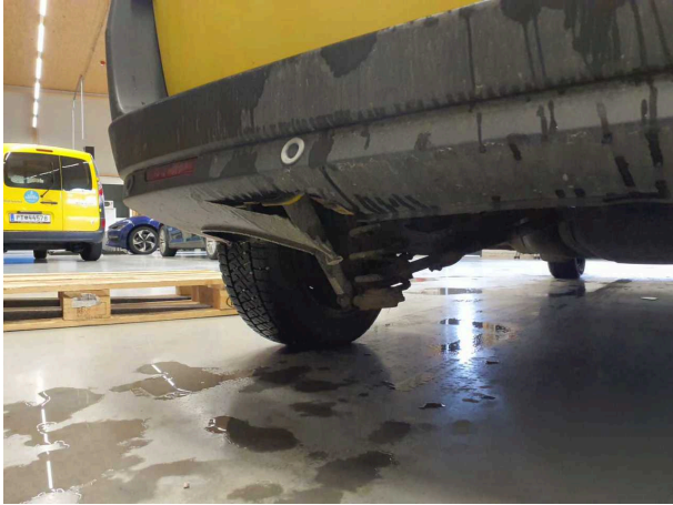
Beschädigung 8: Stossfänger hinten: Stossfänger hinten - beschädigt - erneuern
