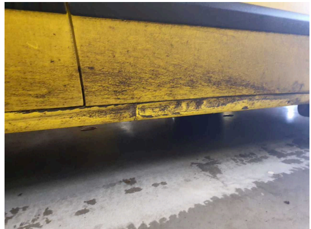
Beschädigung 15: Schweller rechts: Einstieg - beschädigt - instandsetzen und lackieren
