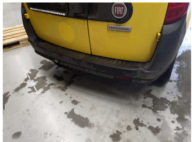
Beschädigung 8: Stossfänger hinten: Stossfänger hinten - beschädigt - erneuern
