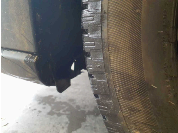
Beschädigung 3: Kotflügel links: Innenkotflügel - beschädigt - erneuern
