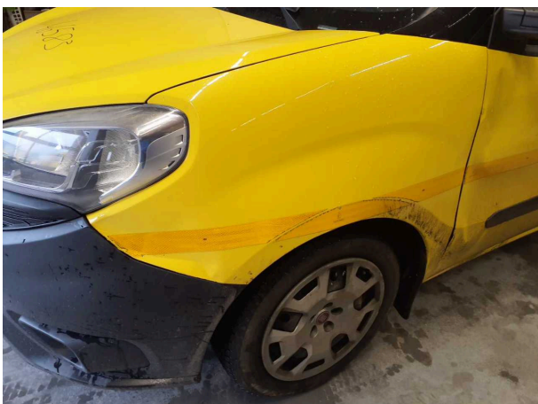
Beschädigung 13: Kotflügel links: Kotflügel links - beschädigt - erneuern
