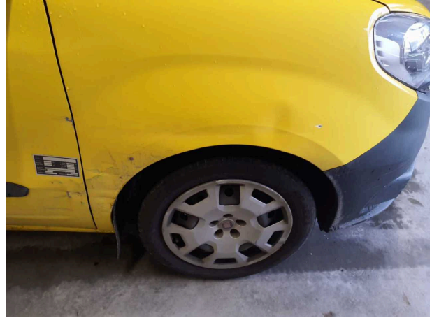
Beschädigung 13: Kotflügel rechts: Kotflügel rechts - beschädigt - erneuern
