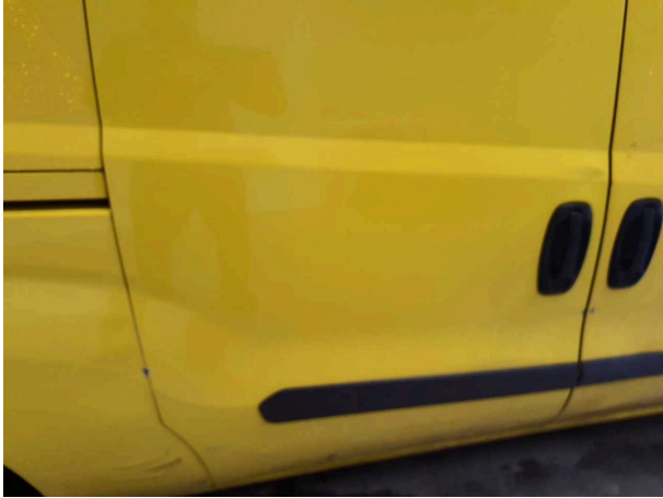
Beschädigung 12: Schiebetür rechts: Schiebetür - beschädigt - instandsetzen und lackieren
