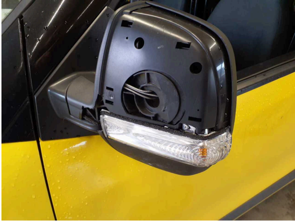
Beschädigung 3: Außenspiegel links: Spiegelgehäuse - beschädigt - erneuern
