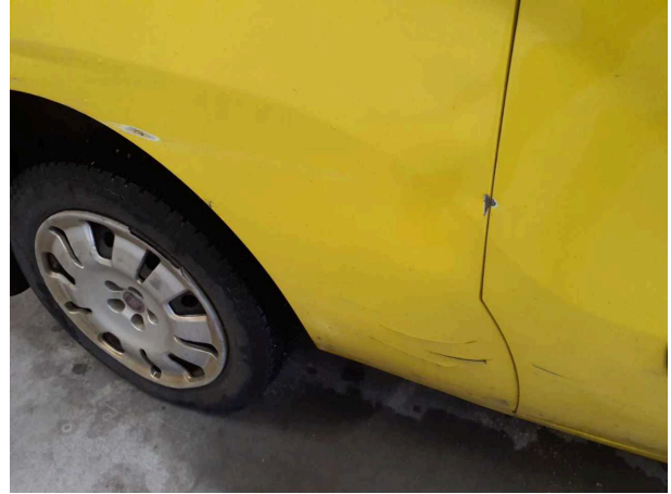
Beschädigung 15: Seitenwand rechts: Seitenwand - beschädigt - instandsetzen und lackieren
