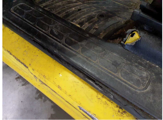
Beschädigung 4: Tür vorn links: Türdichtung - verschlissen - erneuern
