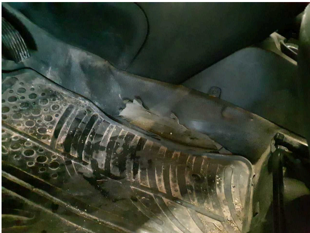
Beschädigung 9: Verkleidungen/Abdeckungen: Teppichboden vorn links - beschädigt - erneuern
