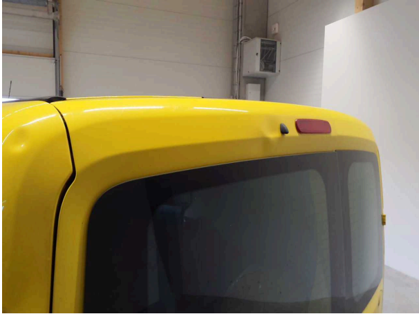
Beschädigung 8: Heckklappe/-tür: Hecktür links - beschädigt - instandsetzen und lackieren
