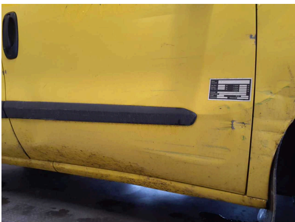
Beschädigung 11: Tür vorn rechts: Tür - beschädigt - instandsetzen und lackieren
