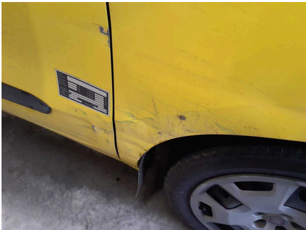
Beschädigung 13: Kotflügel rechts: Kotflügel rechts - beschädigt - erneuern
