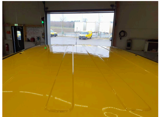
Beschädigung 16: Karosserie: Karosserie - Hagelschaden - sanft instandsetzen
