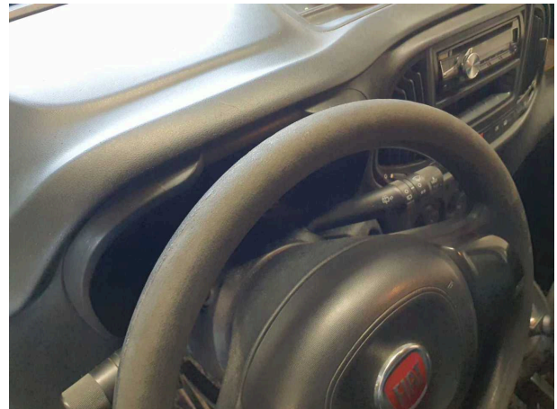
Beschädigung 10: Lenkanlage: Lenkrad - verschlissen - erneuern
