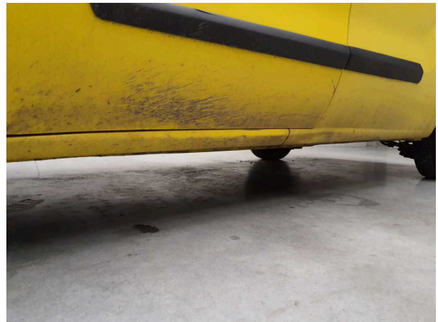
Beschädigung 9: Schweller links: Einstieg - beschädigt - instandsetzen und lackieren
