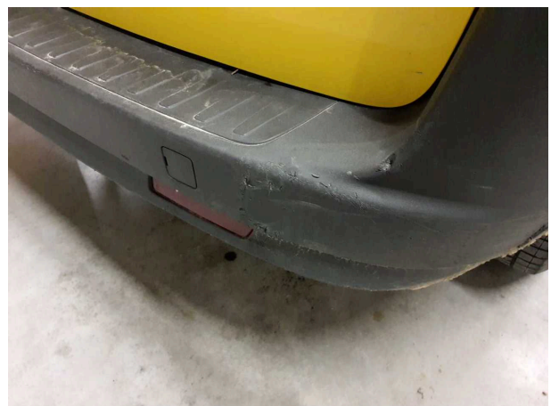
Beschädigung 6: Stossfänger hinten: Stossfänger hinten - beschädigt - erneuern
