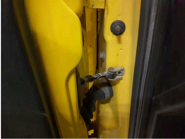
Beschädigung 2: Tür vorn links: Fangband / Feststeller - beschädigt - erneuern
