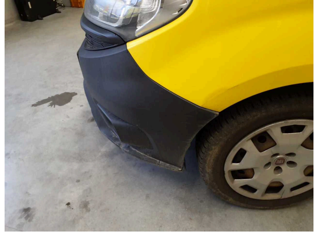
Beschädigung 12: Stossfänger vorn: Stossfänger vorn - beschädigt - erneuern
