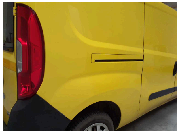
Beschädigung 16: Seitenwand rechts: Seitenwand - beschädigt - instandsetzen und lackieren
