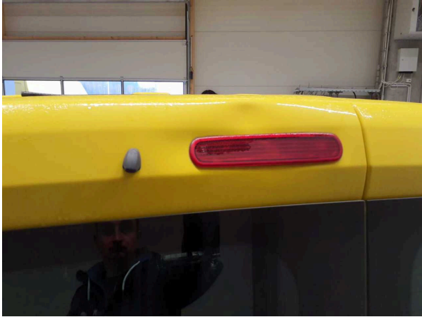
Beschädigung 11: Heckklappe/-tür: Hecktür links - beschädigt - instandsetzen und lackieren
