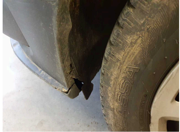
Beschädigung 3: Kotflügel links: Innenkotflügel - beschädigt - erneuern
