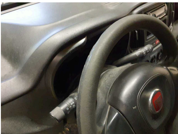
Beschädigung 14: Lenkanlage: Lenkrad - verschlissen - erneuern
