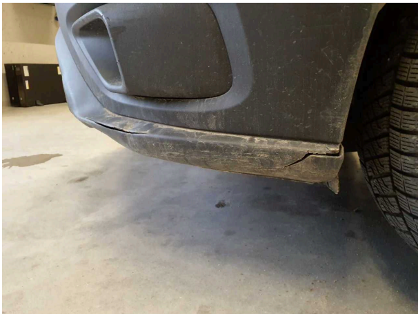
Beschädigung 12: Stossfänger vorn: Stossfänger vorn - beschädigt - erneuern
