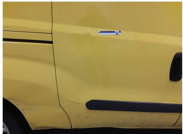
**Gebrauchsspur 3:** Schiebetür rechts: Schiebetür - Delle(n) - kein Abzug
