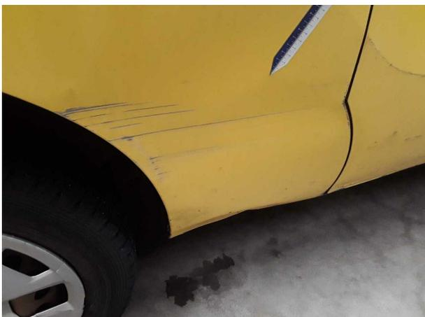
**Beschädigung 8:** Seitenwand rechts: Seitenwand - beschädigt - instandsetzen und lackieren
