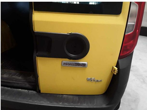
Beschädigung 2: Heckklappe/-tür: Emblem - fehlt - erneuern
