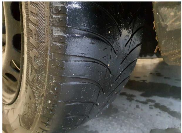
**Beschädigung 6:** Rad/Reifen: Reifen vorn - verschlissen - erneuern
