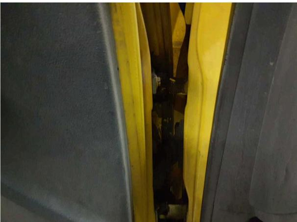
**Beschädigung 5:** Tür vorn links: Fangband / Feststeller - beschädigt - erneuern
