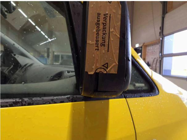
**Beschädigung 3:** Außenspiegel rechts: Spiegelgehäuse - beschädigt - erneuern
