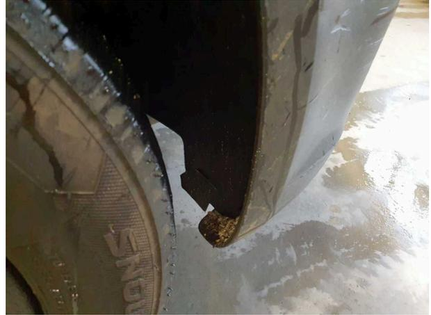
**Beschädigung 2:** Kotflügel rechts: Innenkotflügel - beschädigt - erneuern
