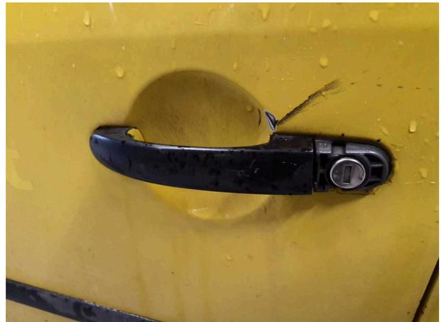
**Beschädigung 4:** Tür vorn links: Schloss / Verriegelung - beschädigt - erneuern
