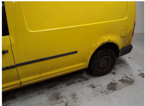
**Beschädigung 13:** Seitenwand links: Seitenwand - beschädigt - instandsetzen und lackieren
