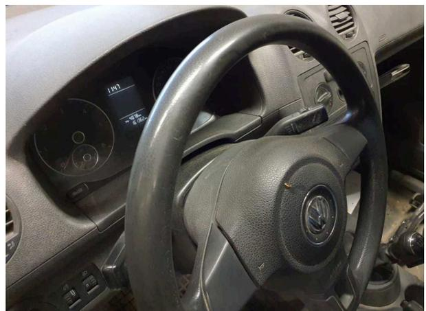
**Beschädigung 9:** Lenkanlage: Lenkrad - verschlissen - erneuern
