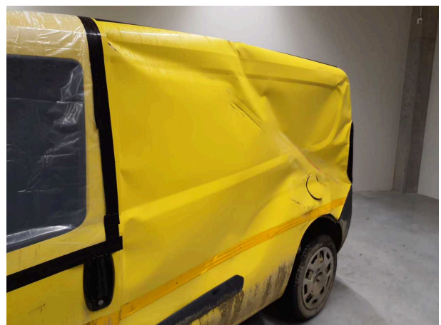
Beschädigung 14: Seitenwand links: Seitenwand - beschädigt - erneuern
