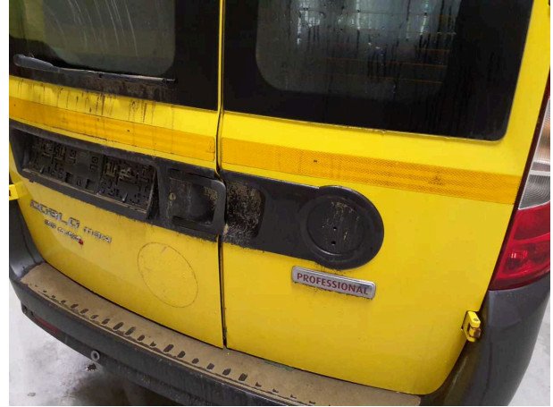
Beschädigung 4: Heckklappe/-tür: Emblem - fehlt - erneuern
