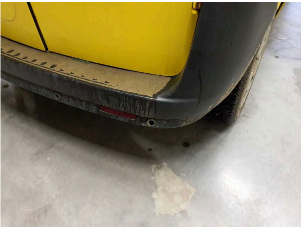
Beschädigung 5: Stossfänger hinten: Parksensoren rechts - fehlt - erneuern
