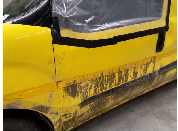
Beschädigung 10: Tür vorn links: Tür - beschädigt - instandsetzen und lackieren
