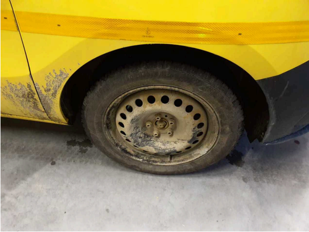
Beschädigung 3: Rad/Reifen: Radblende vorn rechts - fehlt - erneuern
