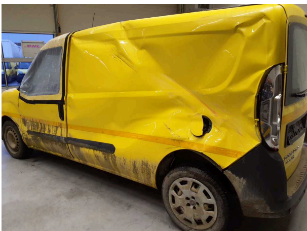
Beschädigung 14: Seitenwand links: Seitenwand - beschädigt - erneuern
