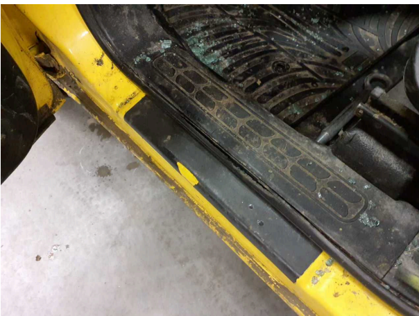
Beschädigung 7: Tür vorn links: Türdichtung - verschlissen - erneuern
