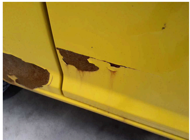
Beschädigung 10: Schiebetür rechts: Schiebetür - beschädigt - instandsetzen und lackieren
