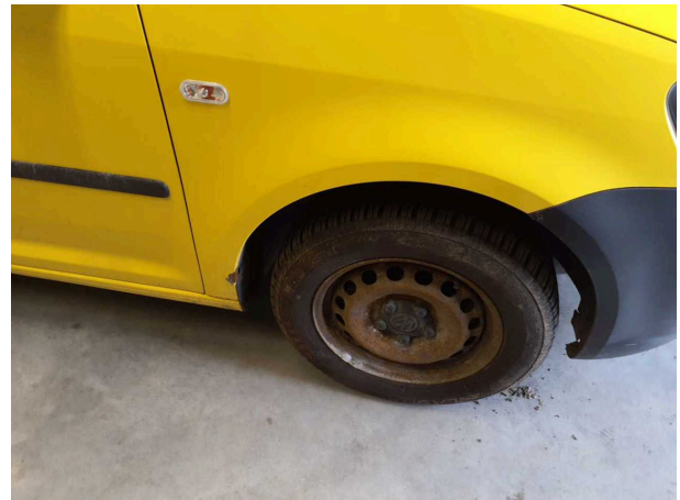
Beschädigung 7: Kotflügel rechts: Kotflügel rechts - Korrosion - instandsetzen und lackieren
