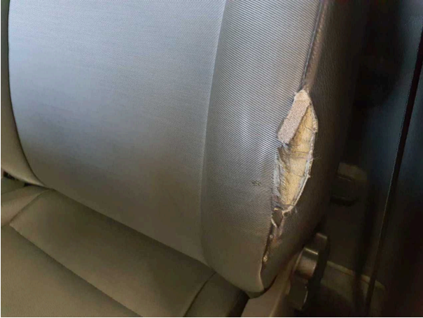
Beschädigung 4: Sitz vorn: Lehnenbezug links - verschlissen - erneuern
