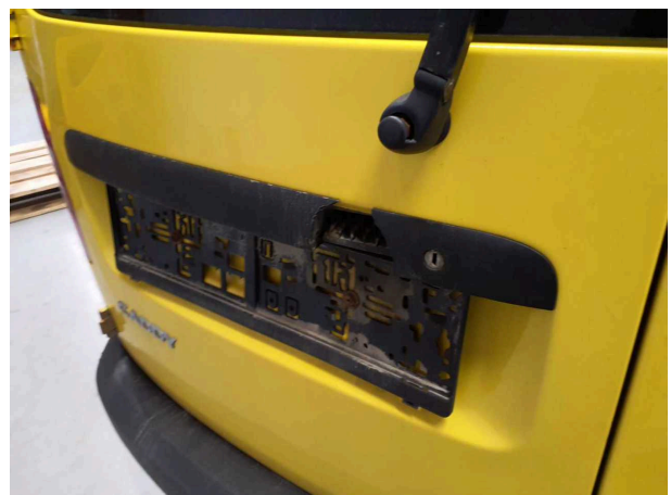
Beschädigung 3: Heckklappe/-tür: Griff außen - beschädigt - erneuern
