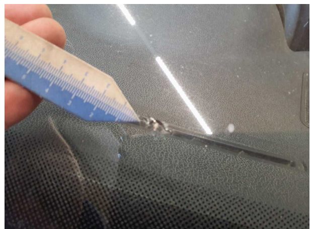
Beschädigung 13: Verglasung: Frontscheibe - beschädigt - erneuern
