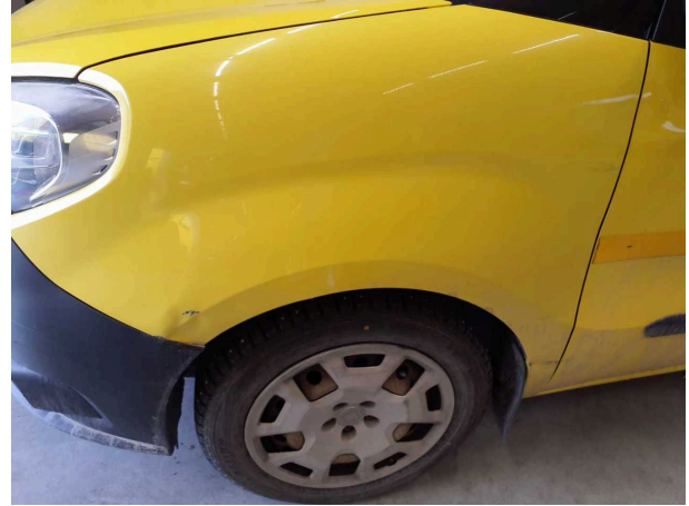
Beschädigung 10: Kotflügel links: Kotflügel links - beschädigt - instandsetzen und lackieren
