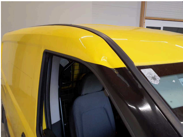
Beschädigung 22: Tür vorn rechts: Tür - beschädigt - erneuern
