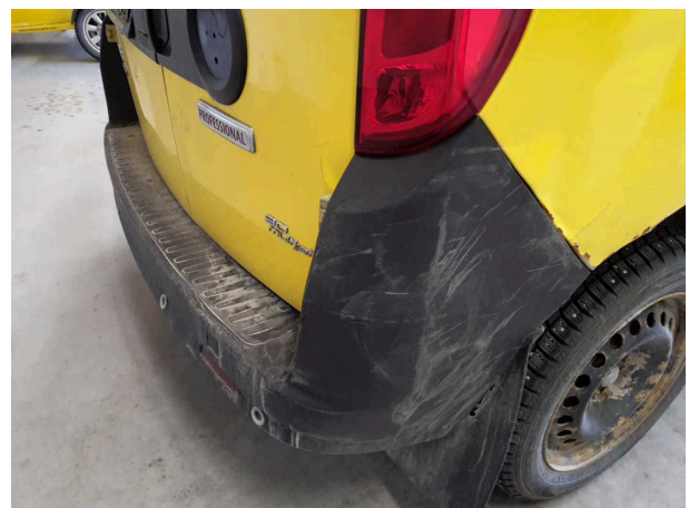
Beschädigung 8: Stossfänger hinten: Stossfänger hinten - beschädigt - erneuern
