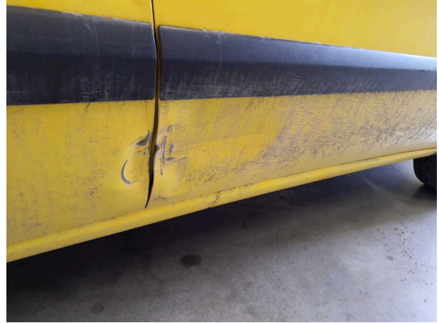
Beschädigung 22: Tür vorn rechts: Tür - beschädigt - erneuern
