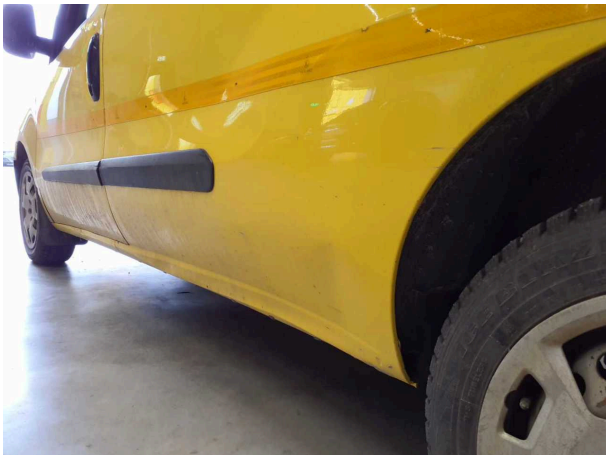
Beschädigung 20: Seitenwand links: Seitenwand - beschädigt - instandsetzen und lackieren
