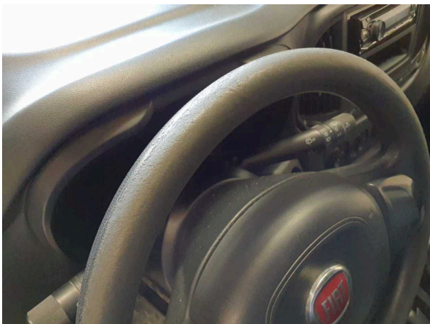
Beschädigung 17: Lenkanlage: Lenkrad - verschlissen - erneuern
