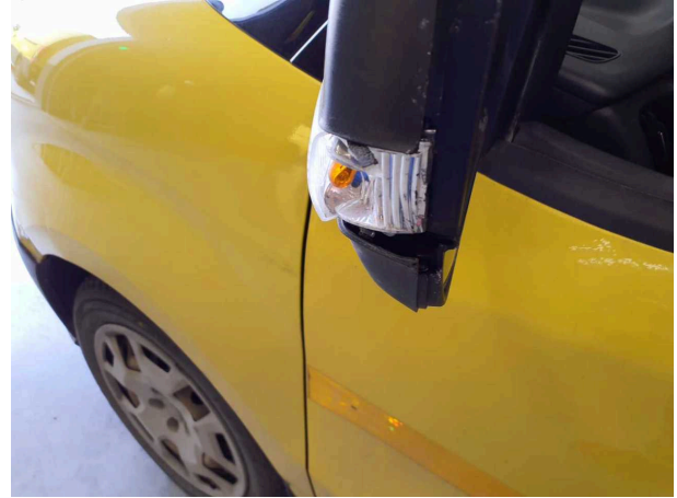
Beschädigung 4: Außenspiegel links: Spiegelgehäuse - beschädigt - erneuern
