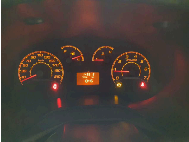
Beschädigung 9: Motor: Motor (Motorkontrolle) - Befund festlegen - Diagnose durchführen
