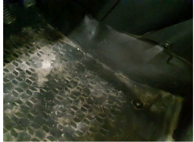
Beschädigung 16: Verkleidungen/Abdeckungen: Teppichboden vorn links - verschlissen - erneuern
