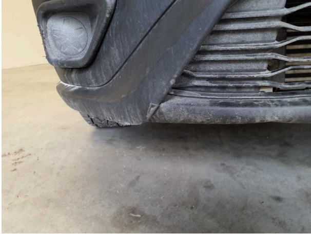
Beschädigung 14: Stossfänger vorn: Stossfänger vorn - beschädigt - erneuern
