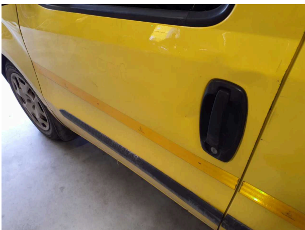
Beschädigung 13: Tür vorn links: Tür - beschädigt - instandsetzen und lackieren
