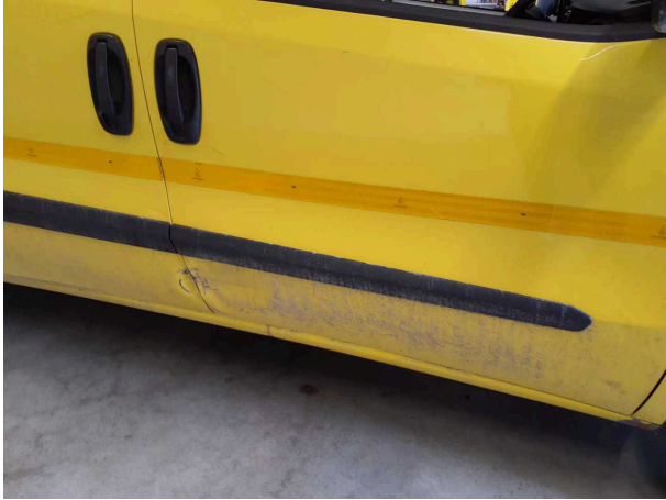
Beschädigung 22: Tür vorn rechts: Tür - beschädigt - erneuern
