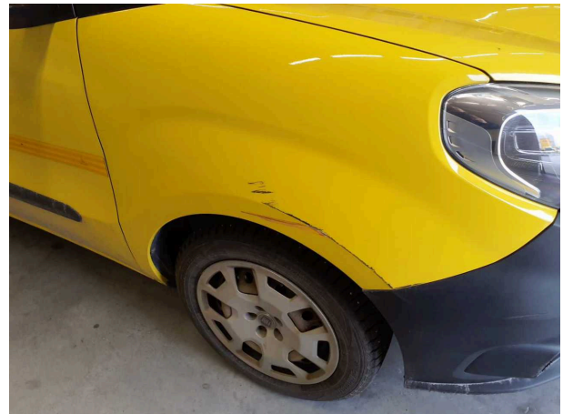
Beschädigung 11: Kotflügel rechts: Kotflügel rechts - beschädigt - instandsetzen und lackieren
