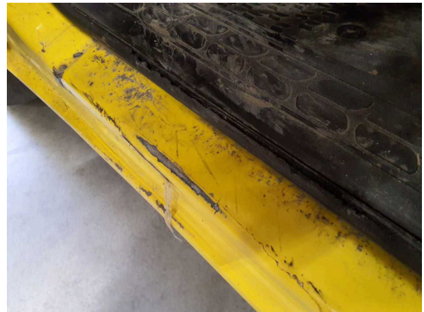
Beschädigung 6: Tür vorn links: Türdichtung - verschlissen - erneuern
