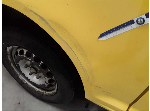
Gebrauchsspur 3: Seitenwand rechts: Seitenwand - Delle(n) - kein Abzug
