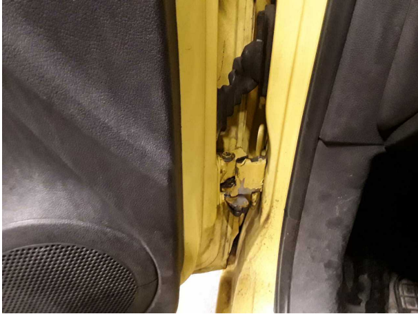
Beschädigung 4: Heckklappe/-tür: Scharnier unten (270 Grad) - Spiel - erneuern
