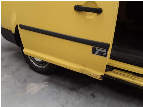
Beschädigung 9: Schiebetür rechts: Schiebetür - beschädigt - instandsetzen und lackieren
