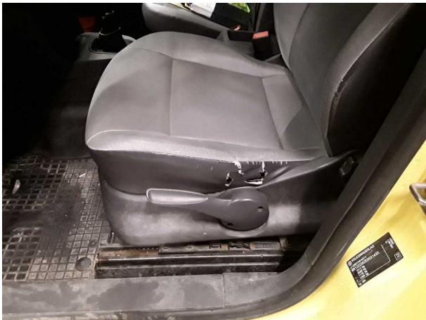
Beschädigung 6: Sitz vorn: Sitzbezug links - verschlissen - erneuern
