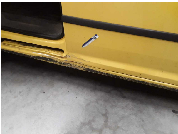
Beschädigung 7: Tür vorn rechts: Tür - beschädigt - instandsetzen und lackieren
