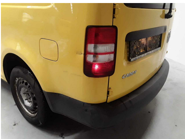
Beschädigung 3: Heckleuchte: Heckleuchte links - undicht - erneuern
