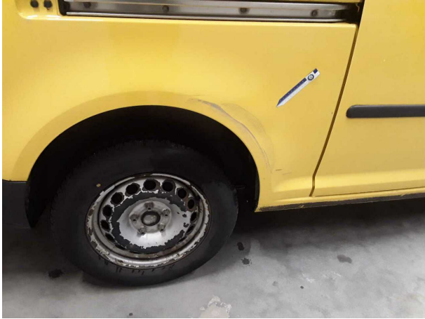
Gebrauchsspur 3: Seitenwand rechts: Seitenwand - Delle(n) - kein Abzug
