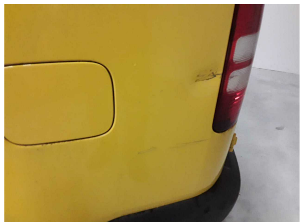
Beschädigung 10: Seitenwand links: Seitenwand - beschädigt - instandsetzen und lackieren
