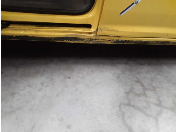
Beschädigung 8: Schweller rechts: Einstieg - beschädigt - instandsetzen und lackieren
