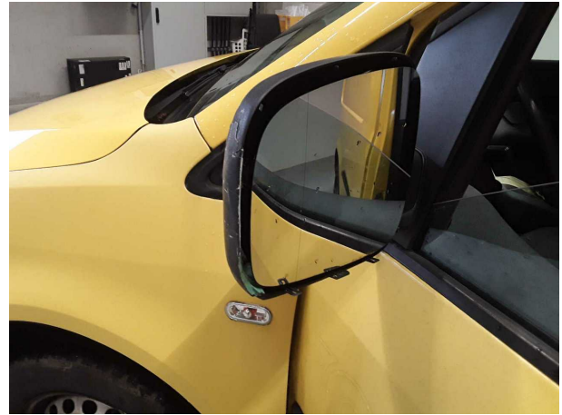
Beschädigung 1: Außenspiegel links: Abdeckkappe - gebrochen / gerissen - erneuern
