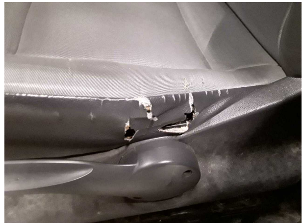
Beschädigung 6: Sitz vorn: Sitzbezug links - verschlissen - erneuern
