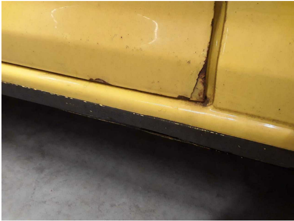
Gebrauchsspur 5: Tür vorn links: Tür - Korrosion - kein Abzug
