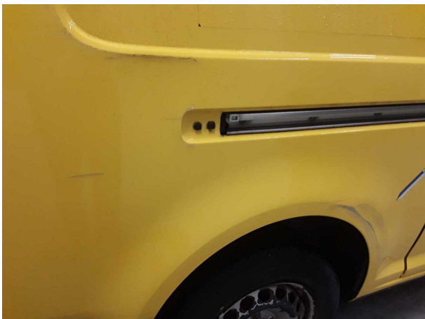
Beschädigung 2: Schiebetür rechts: Führungsschiene (Blende) - fehlt - erneuern
